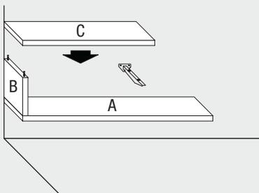
Das obere Bord C auf den oberen Montagewinkel legen und mit dem beiliegenden Montageset an Seitenwand B befestigen. Danach die waagerechte Ausrichtung der Zusammenstellung prüfen und das gesamte C-Element an den drei Montagewinkeln befestigen. Dies erfolgt mit Hilfe von selbstschneidenden Schrauben, die durch die Öffnungen der Messinghülsen jeweils von unten verschraubt werden.
