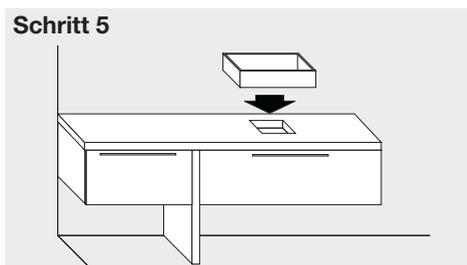
Waschtisch, Mischbatterie und Ablauf befestigen. Diese Vorgänge werden durch das Entfernen der Schublade erleichtert.
