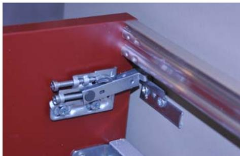
Bevor Sie loslassen, prüfen Sie durch eine weitere Person die exakte Verbindung zwischen Möbel-Kupplung und Befestigungswinkel.
