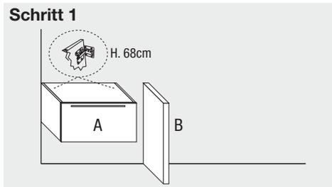
Unterschrank A an der Wand befestigen, auf der gleichen Höhe wie den vertikalen Fuß B (680 mm). Sind Schubkästen oder Türen vorhanden, ist der Vorgang leichter, wenn diese zuvor entfernt werden.
