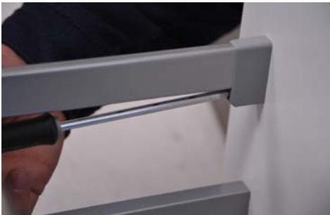
Durch Drehen der Schraube unter der Schubladen-Schiene können Sie die Rechtwinkligkeit der Front justieren.
