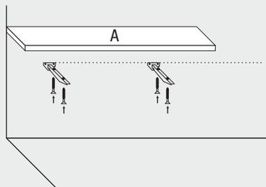
Die Waschtischplatte A auf die Montagewinkel legen, danach die waagrechte Ausrichtung der Waschtischplatte prüfen und an den zwei Montagewinkeln befestigen. Dies erfolgt mit Hilfe von selbstschneidenden Schrauben, die jeweils von unten verschraubt werden.
