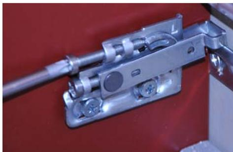
Nach dem Einhängen des Schrankes nehmen Sie nun die horizontale Ausrichtung des Möbels vor, indem Sie an der oberen Schraube des Befestigungsscharniers drehen (siehe Abbildung).
