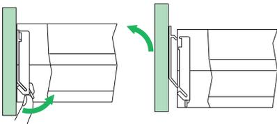
Um die Schubladenfront zu entfernen, drücken Sie die Blockiervorrichtung von der Front weg und haken Sie die Front aus.
