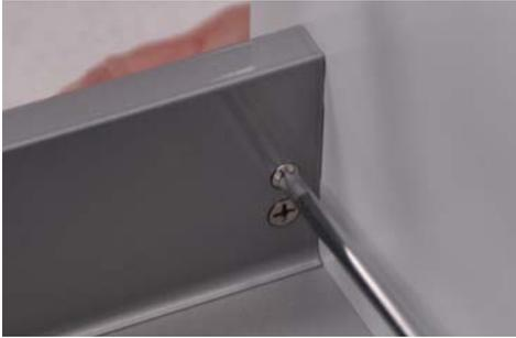
Bevor Sie irgendwelche Einstellungen vornehmen, lösen Sie zuerst die Sicherungsschraube (oben). Nach der Feinjustierung schrauben Sie diese wieder fest.
