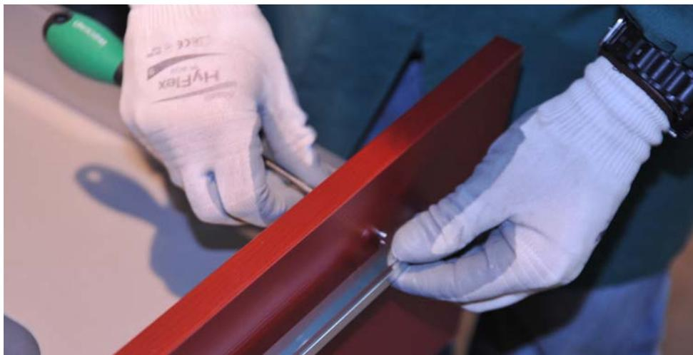
Die Griffe immer von innen anschrauben. Der häufigste Fehler beim Anschrauben von Griffen ist, dass versucht wird, die Griffe direkt von vorne auf die Front zu schrauben. Dieser Fehler zerkratzt / beschädigt die Oberfläche des Möbels und ist im Schadensfall kein Reklamationsgrund.
