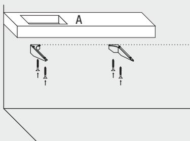
Den Waschtisch A auf die Montagewinkel legen, danach die waagrechte Ausrichtung des Waschtisches prüfen und an den zwei Montagewinkeln befestigen. Dies erfolgt mit Hilfe von selbstschneidenden Schrauben, die jeweils von unten in die unter dem Waschtisch vorhandenen Holzelemente verschraubt werden.
