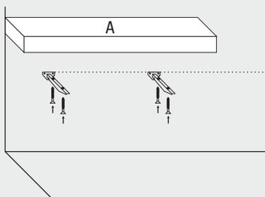
Die Waschtischplatte A auf die Montagewinkel legen, danach die waagrechte Ausrichtung der Waschtischplatte prüfen und an den zwei Montagewinkeln befestigen. Dies erfolgt mit Hilfe von selbstschneidenden Schrauben, die jeweils von unten verschraubt werden.
