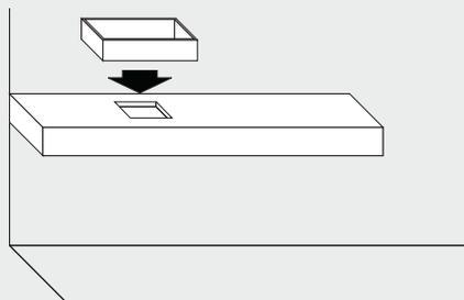
Nun das Waschbecken auflegen und mit dem eigenen Montageset befestigen. Dann die Mischbatterie /Armatur montieren. ACHTUNG: Die Wasser-Zu- und Abflüsse müssen von spezialisierten Technikern ausgeführt werden.
