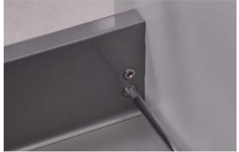
Durch Drehen der unteren Schraube können Sie die Höhe der Vorderseite justieren.
