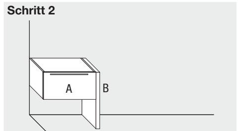
Den Unterschrank A von innen in Höhe der Vorbohrungen durchbohren (Holzbohrer 8 mm). Dann den vertikalen Fuß B an den Schrank A anlegen und vom Inneren des Schrankes aus mit den Schrauben, die dem Bausatz beiliegen, befestigen. Ist eine Schublade vorhanden, muss diese vorher entfernt werden.
