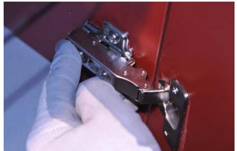
Das Einhängen des Scharniers in die Basis erfolgt automatisch durch Druck auf das hintere Scharnierteil. Dabei entsteht ein hörbares "KLICK" im Scharnier.
