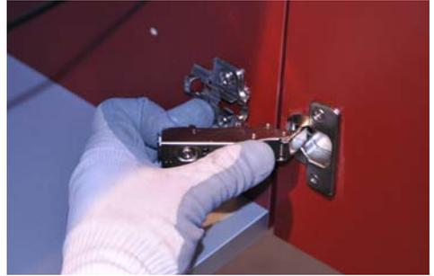
Drücken Sie den Knopf und ziehen Sie am Scharnier, um dieses von der Basis loszuhaken.
