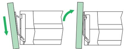
Für die Montage der Schubladenfront schieben Sie die Feststellhaken der Front in die abgeschrägte untere Aussparung ein (Nullstellung). Dann die Front zuerst nach innen drehen und eindrücken.
