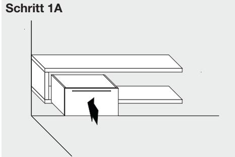
Den Schubkasten (falls vorhanden) aus dem Schrank entfernen, dadurch wird die Montage des Schrank vereinfacht. Den Schrank ins "C"-Element einsetzen. Falls nötig, kann dieser am Element mit einer selbstschneidenden Schraube befestigt werden, die von innen an der Abdeckung des Schrank angebracht wird.
