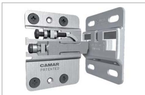
Das Einhängen der Befestigungsscharniere in den Befestigungswinkel erfolgt durch das Einschleiben der Halterung in den Sitz der Basis. Das Metallband verhindert ein Aushaken des Möbels.
