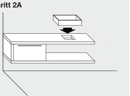
Das Waschbecken auflegen und mit dem eigenen Montageset befestigen, die Mischbatterie montieren.
