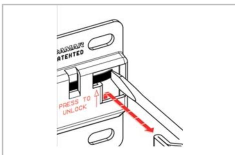
Das Lösen des Möbels vom Befestigungswinkel erfolgt durch Drücken mit einem Schraubendreher auf das Metallband.
