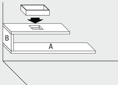
Nun das Waschbecken auflegen und mit dem eigenen Montageset befestigen. Dann die Mischbatterie /Armatur montieren. ACHTUNG: Die Wasser- und abflüsse müssen von spezialisierten Technikern ausgeführt werden.
