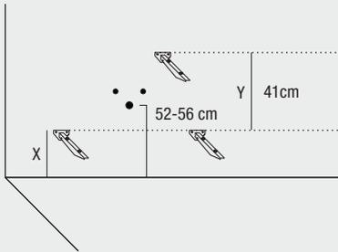
Die 3 Montagewinkel nach dem gezeigten Schema an der Wand befestigen. Die Höhe X für die beiden unteren Montagewinkel beträgt normalerweise 30 cm ab Fußboden, kann aber nach den Bedürfnissen des Kunden verändert werden. Der Abstand Y zwischen den unteren Montagewinkeln und dem oberen muss unbedingt eingehalten werden. Die Montagewinkel so platzieren, dass diese abhängig von den Abmessungen des C-Elements unter den Borden des C-Elements verschwinden und nicht rechts oder links sichtbar sind.
