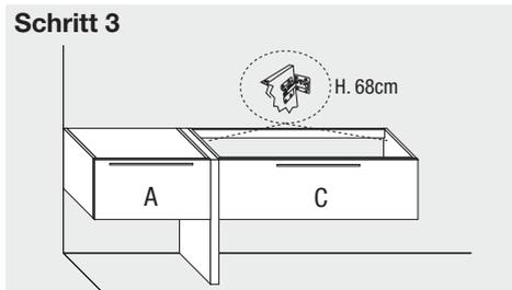
Den Waschtisch-Unterschrank C auf der gleichen Höhe des vertikalen Fußes B (680 mm) befestigen. Der vertikale Fuß ist bereits ab Werk angebohrt für die Befestigung der seitlich anzubauenden Unterschränke (Waschtisch-Unterschränke und Unterschränke Höhe 24, 36 und 48 cm).
