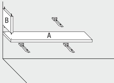
Das untere Bord A auf die unteren zwei Montagewinkel legen, dann Element B montieren. Dazu das mitgelieferte Montageset verwenden (Schrauben-Distanzstücke-Holzdübel).
