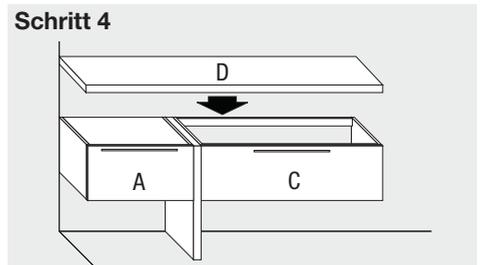
Die Waschtischplatte auf den Korpus auflegen und mit einer selbstschneidenden Schraube von der Innendecke des Schrankes A aus befestigen. Ein transparenter Silikonstreifen kann ausschließlich an der Innenkante des Schrankes C und an der Oberkante des vertikalen Fußes angebracht werden.
