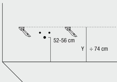
Die 2 Montagewinkel nach dem gezeigten Schema an der Wand befestigen.
