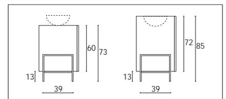
STRUCTURA-Element Höhe 35 cm (beidseitig verwendbar) mit Unterschrank H 60 (mit Auflagebecken) bzw. H 72 cm (mit fugenlosem Waschtisch)
