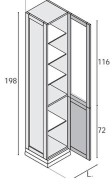
Hochschrank mit 1 Tür, 4 Glas-Einlegeböden (fix) und 1 Holz-Einlegeböden (fix).
