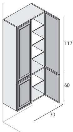
Hochschrank mit 4 Türen, 4 Glas-Einlegeböden (fix, durchgehend), 1 Holz-Einlegeboden (fix).
