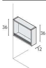
Seitenregal für Schränke, als Ausführung rechts oder links (Abb.). Bord mit Anti-Kipp-Glasleiste.
