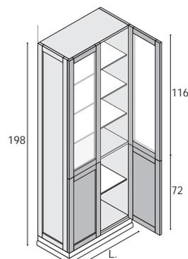
Hochschrank mit 2 Türen, 4 Glas-Einlegeböden (fix, durchgehend), 1 Holz-Einlegeboden (fix).
