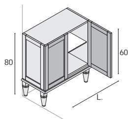
Unterschrank mit 4 Füßen, 2 Türen, 1 Glas-Einlegeboden (fix,
