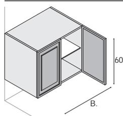
Unterschrank mit 2Türen, 1 Glas-Einlegeboden (fix, durchgehend).
