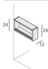
Seitenregal für Schränke, als Ausführung rechts oder links (Abb.). Bord mit Anti-Kipp-Glasleiste.
