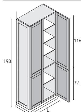
Hochschrank mit 4 Türen, 4 Glas-Einlegeböden (fix, durchgehend), 1 Holz-Einlegeboden (fix).
