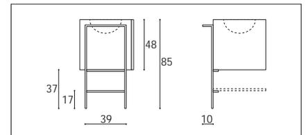
STRUCTURA-Element Höhe 80 cm (beidseitig verwendbar) mit Unterschrank H 48 cm mit fugenlosem Waschtisch
