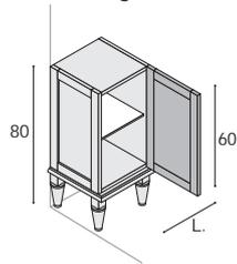
Unterschrank mit mit 4 Füßen, 1 Tür, 1 Glas-Einlegeboden (fix).
