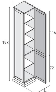
Hochschrank mit 2 Türen, 4 Glas-Einlegeböden (fix, durchgehend), 1 Holz-Einlegeboden (fix).
