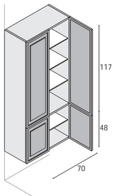
Hochschrank mit 4 Türen, 4 Glas-Einlegeböden (fix, durchgehend), 1 Holz-Einlegeboden (fix).
